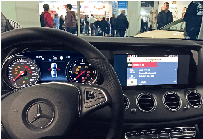
fms stellte ein VW- und MB-Taxi aus, in dem das Fahrzeugdisplay als Bedienterminal dient.
